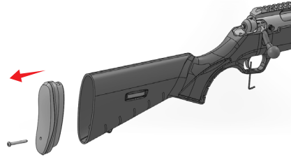
Şekil 28: Dipçik taban lastiği dipçikten ayrılır.
