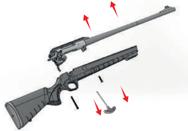
Şekil 25: Kundağ ve gövde birbirinden ayrılır.
