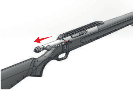
Şekil 18: Mekanizma grubu geriye çekilerek mermi, mermi yatağına alındıktan sonra tekrar ileri ve aşağı saat yönünde itirilir.
