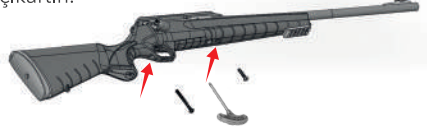
Şekil 24: Kundağ ve gövde arasında bulunan iki vida çıkartılır.
